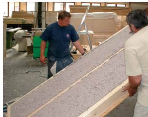
Obr. 2: Materiál po aplikaci s objemovou hmotností okolo 60 \text{ kg/m}^3 je stabilní, nesedá a zůstává ve vymezeném prostoru, aniž by vypadal
